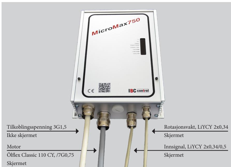
EMC-forskruing skal benyttes til skjermet kabel.
